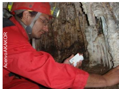
Datalogger TESTO registra umidade e temperatura
